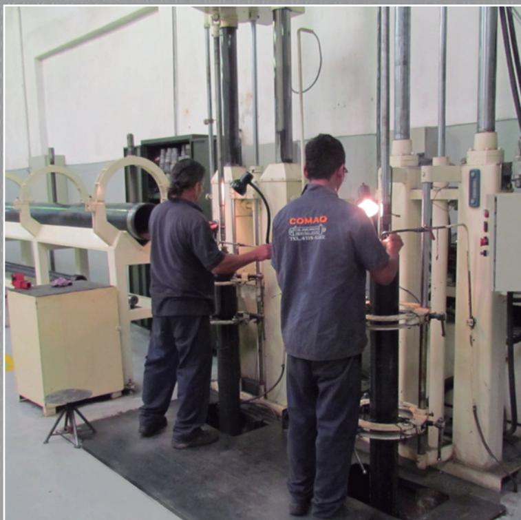
Com capacidade de brunimento máximo de até 600mm x 12mts de comprimento. Todo o processo de desbaste e acabamento interno é controlado por meio de instrumentos de medição de precisão nas dimensões internas e de rugosidade.
