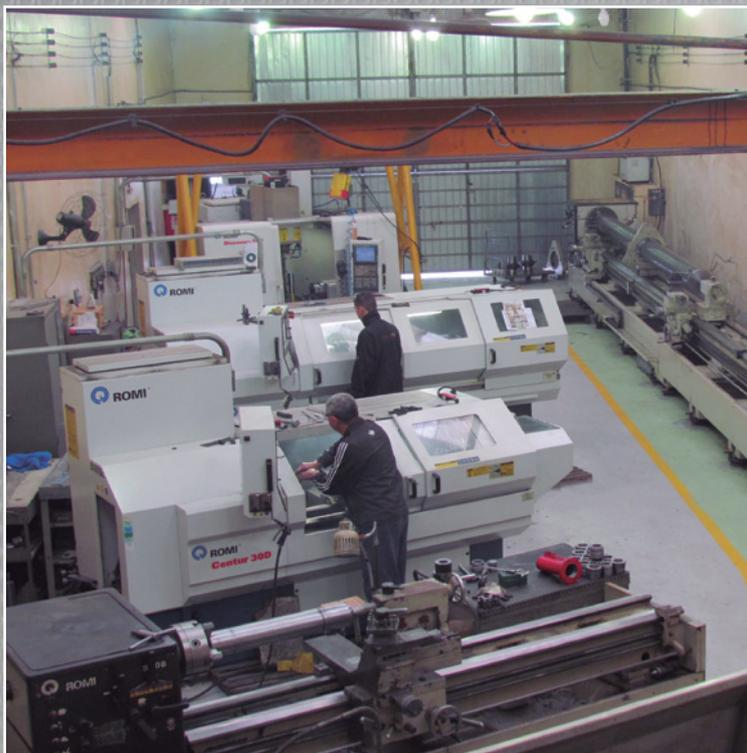
No setor de usinagem convencional são designadas peças para remanufatura e fabricação de grande porte, com capacidade para usinagem de diâmetros de 600mm até 12m de comprimento.
