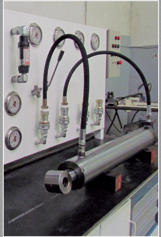
Com controlos rigorosos todos os cilindros são desmontados, limpos e examinados, após este processo são realizados testes de pressão, estanqueidade interna e controle externo de vazamento.
